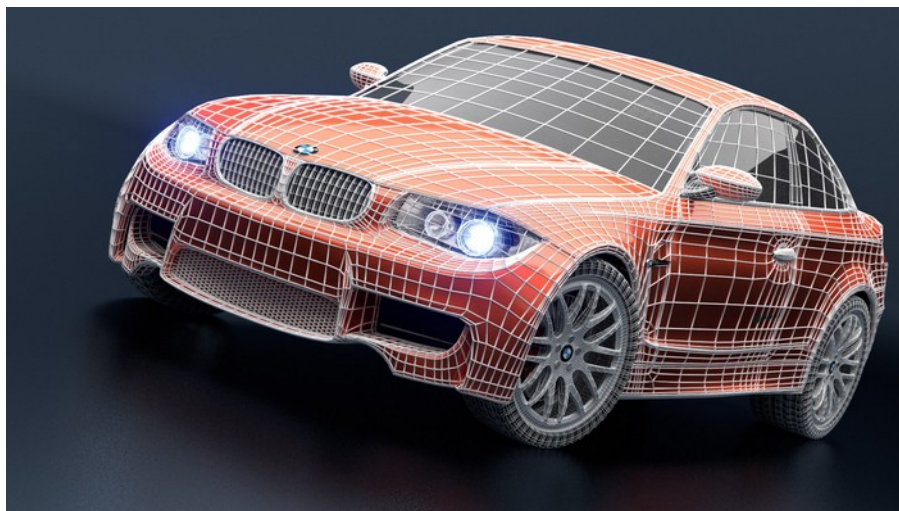
Spiderman autója? Az árnyalt modell feletti hálóval láthatóvá válik, hogyan modellezték az alakzatot. (Forrás: blenderguru.com)
