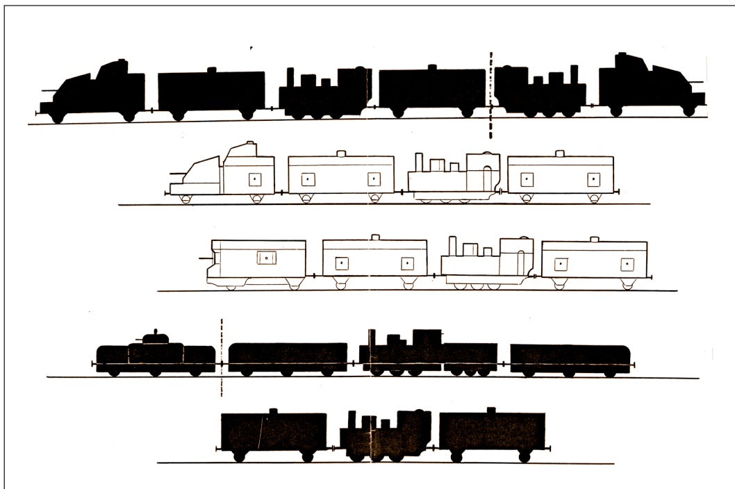
51. ábra: A K. u. K. páncél- vonatok eredeti felépítése az I. világháború időszakában 1915–1918. (É. M.)
