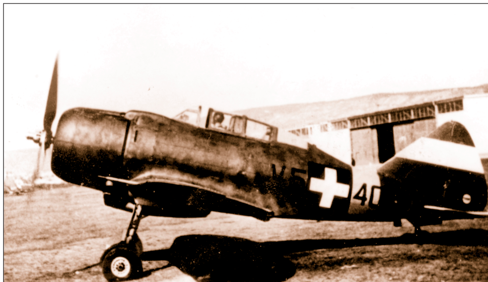
57. ábra: A MÁVAG Héja-M vadászgép (V5+40) a beépített 2 db 12,7 mm-es Gebauer géppuskával (W. L.)
