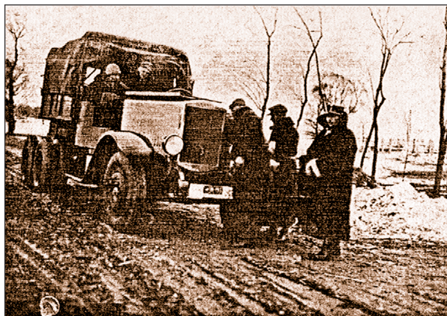
52. ábra: A Krupp 6x4-es tehergépkocsi próbái 1930 körül (H. A.)
