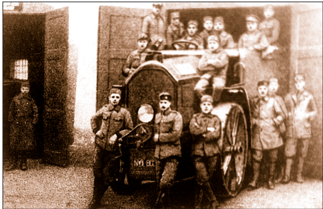
7. ábra: Austro-Daimler 1917 M. tüzérségi vontató a nehéz mozsarak számára (S. Gy.)
