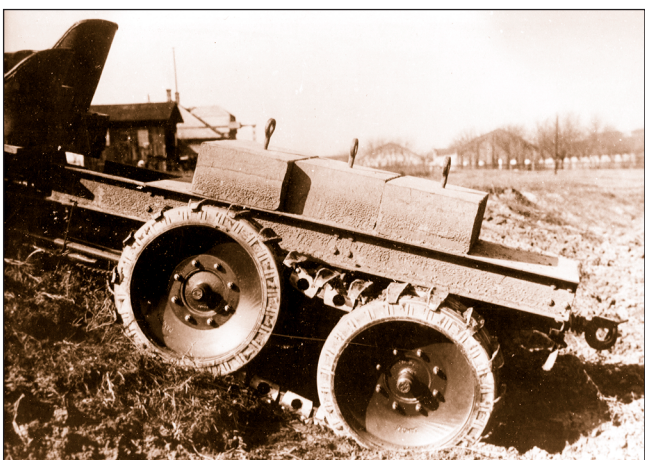
49. ábra: A WM H-1 teherautó próbái felszerelt kiegészítő láncdalppal Csepelen, a Korbuly tanya közelében 1929-ben (H. A.)
