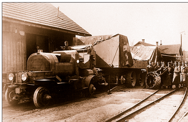
15. ábra: Az Austro-Daimler Puchwerke AG 120 LE-s, 6 hengeres C-Zug vontatója, itt vasúti kerékre szerelve egy 42 cm-es mozsarat továbbít, 1915-18 (S. Gy.)
