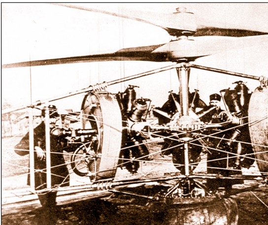
35. ábra: Jól látható a PKZ-2 helikopter motorjainak elrendezése (W. L.)
