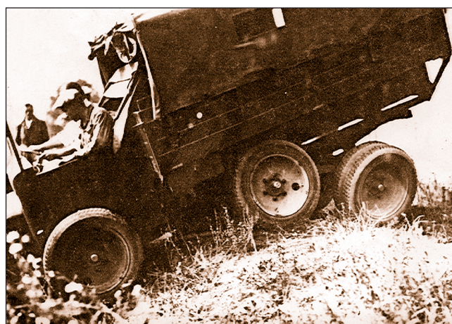
54-55. ábra: Az La-2 50 LE-s motorral szerelt WM H-2 tehergépkocsi terepr próbái (H. A.)
