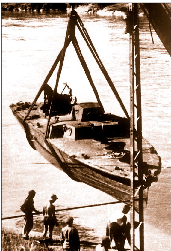
90-91. ábra: A PAM 21 és PAM 22 páncélos aknász motorcsónakokat 1945 nyarán Passauban kiemelik a Dunából, és partra teszik. A fegyverzetük már el van távolítva (S. Gy.)
