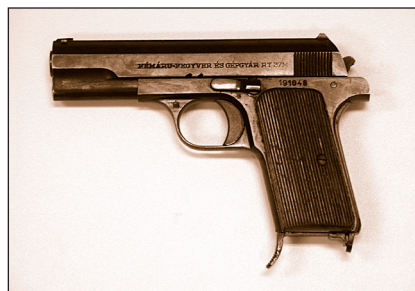
46. ábra: Az 1937 M. Frommer pisztoly 9 mm-es változata (H. F.)
