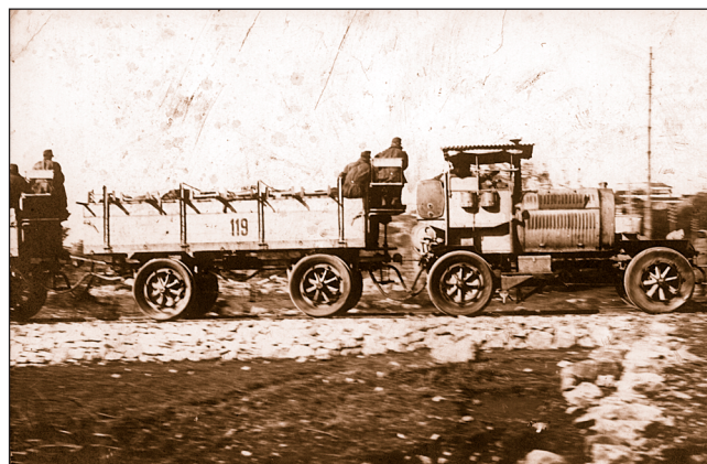
16. ábra: A C-Zug vontató a nehéztüzérség pótkocsiját továbbítja, 1916-18 (S. Gy.)
