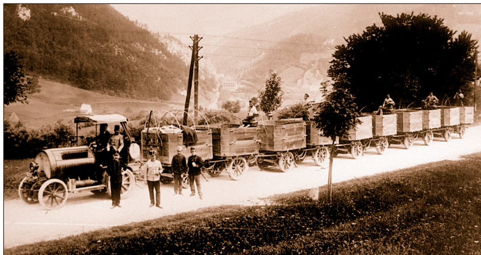
12. ábra: A Landwehr Train országúti változata a semmeringi próbán 1914 előtt. Minden pótkocsi belső pólusú elektromotorral meghajtott volt (S. Gy.)
