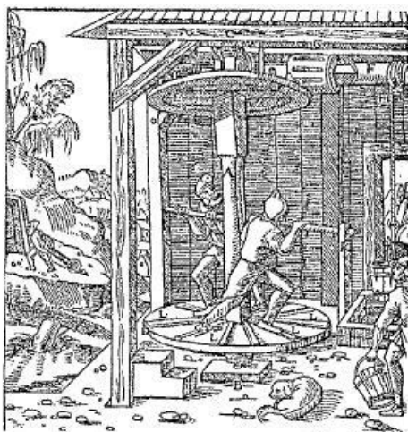
6. ábra. Taposókorongos felvonó a kén-dioxid és szén-dioxid jelzésére szolgáló kutyával.
