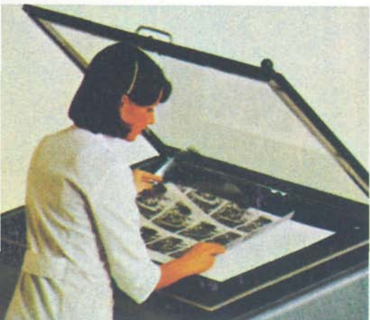
FÉNYMÁSOLÓ KERET, amelyben ultraibolya fénnel másolják a rácspozitív filmet a fotopolimer réteggel felhordott papírranyagra
