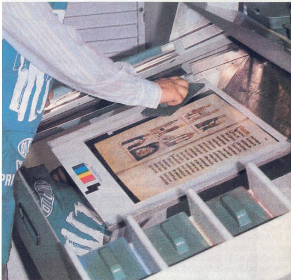
POROZÁS. A védőfólia eltávolítása után szűrmetampon segítségével porozzák be a papíron levő megvilágított fotopolimer réteget. A festékpórt csak a megvilágítatlan részekben tapad meg, a megvilágított (a képen kívüli) részéről letörölhető. Az elszívó berendezés összegyűjtheti a festékpórt
