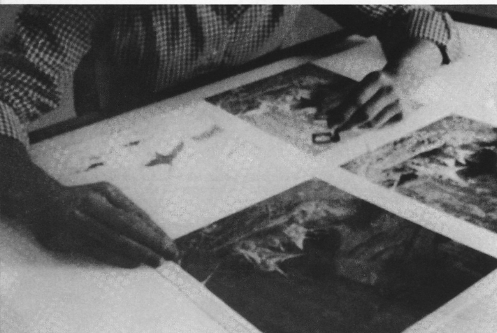
ELLENŐRZÉS. A színbontógépen elkészült színkivonatokat ellenőrzik. Szabad szemmel, majd nagyítóval történik az első ellenőrzés. Ezt követi a műszeres vizsgálat. Denzitométerrel a színkivonatok fedettségét, a legvilágosabb és a legsötétebb rész értékeit az eredetivel összevetve vizsgálják meg. Eltérés esetén kézi beavatkozással, retussal teszik további feldolgozásra alkalmassá a színkivonatokat
