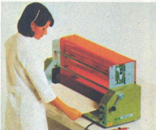
A CROMALIN ELJÁRÁSHOZ használt fotopolimer réteggel ellátott filanyagot ezen a Laminátor felrétegező gépen kasírozzák össze a papírranyaggal
