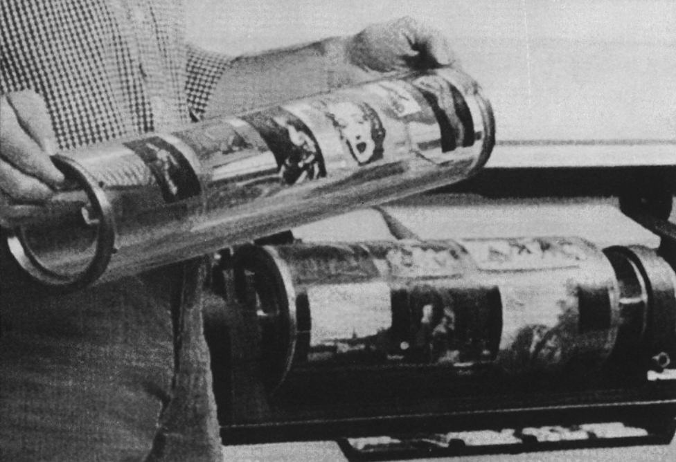
HENGERCSERE. A színbontógépek eredet tartó hengerét cserélni lehet. A hengerkerület változtatása a méretváltoztatás egyik módja
