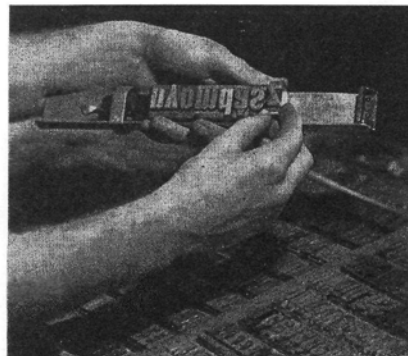
A kéziszedés munkaeszköze a szedővas: a winkel
