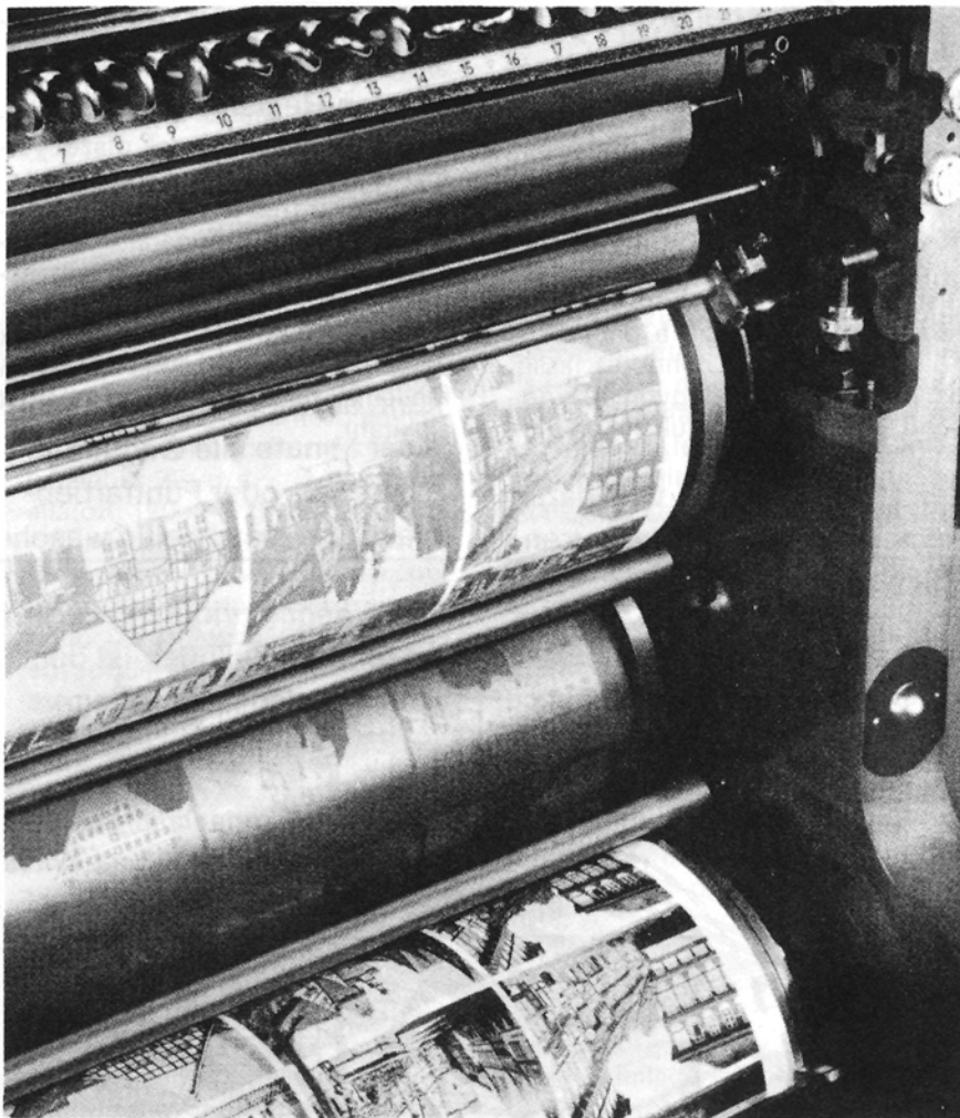
OFSZET GÉP NYOMÓ RÉSZE. A nyomóforma forgása közben a vizezőhengerekkel találkozik először. A nedvesítésnél a nemnyomó felületek finom vízhártyával vonódnak be. A közvetlenül rágördülő festékezőhengerek a nedves (nemnyomó) részekre nem adnak le festéket, viszont a nyomóelemek felveszik azt. A formahenger ezután a közvetítő gumihengernek adja át a nyomatot, tehát nem nyom közvetlenül a papírra. A gumihenger forgása közben a papírt hordozó hengerrel is érintkezik és ekkor közvetíti a nyomatot a papírra
